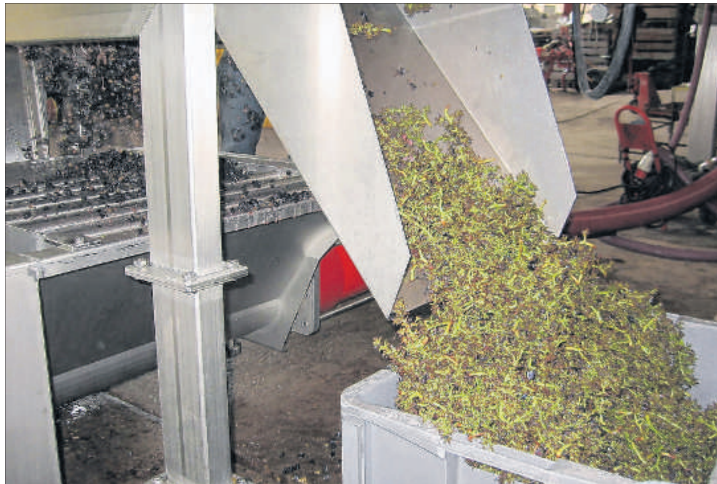
Le nouvel égrappoir permet un tri efficace des baies qui restent intactes. Les rafles sont évacuées.
